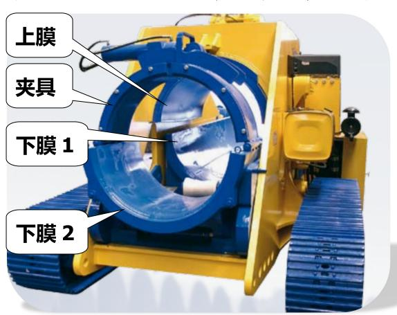
弯管机型号不同外膜尺寸不同: 同一弯管 机管径不同外膜尺寸不同:
