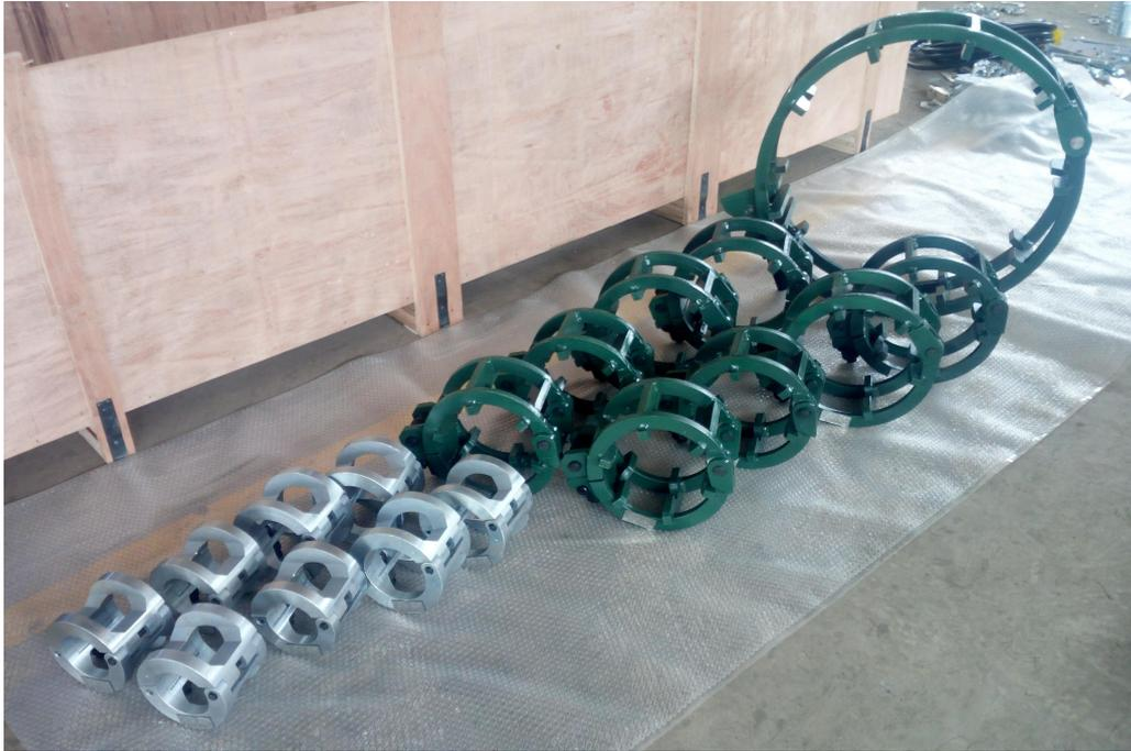
管道外用对口器是长输管道、支线管道、城市燃气输水管道及炼化、电力等厂区管道组对的关键施工设备；它虽然没有内对口器效率及精度高，但是相对于传统对口作业而言具有体积小、重量轻、操作方便、安全可靠等特点；并相对于传统对口作业可以提高效率、对口精度 200%以上。
